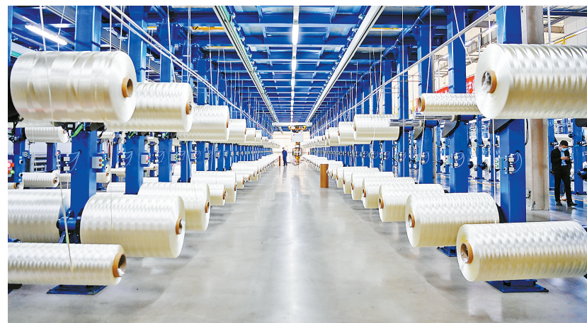
工人在吉林化纤集团国兴碳纤维公司生产车间整理碳纤维原丝。(新华社记者 颜麟蕴 摄)
